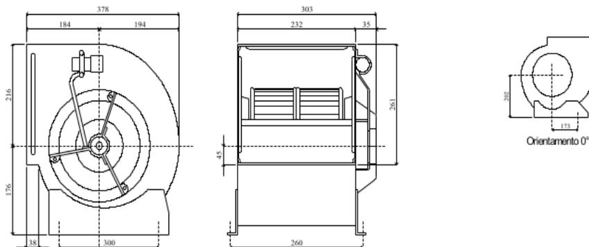
Diametro ventola - Fanweel diameter - Diamètre turbine : 250 [mm]
