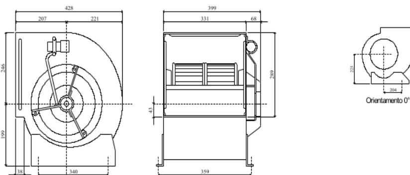
Diametro ventola - Fanweel diameter - Diamètre turbine : 280 [mm]
