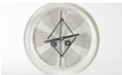
Il sistema di regolazione automatica della posizione delle pale è realizzato con molle in acciaio armonico ad effetto termostatico le quali consentono di posizionare correttamente e simultaneamente le pale del diffusore in base alla temperatura dell'aria immessa per ottenere il lancio adeguato.
