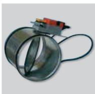
**Serrande motorizzate** circolari con corpo in acciaio zincato e motorizzazione controllata da una sonda di CO<sub>2</sub>. Il servomotore funziona proporzionalmente al segnale 0-10V inviato dalla sonda. Intercalando il modulo BEAS si può ottenere la posizione minima e massima. Si utilizzano nei sistemi di ventilazione multizona di tipo proporzionale.
