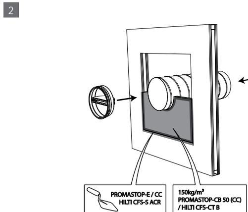
2. L'apertura nella parete attorno al canale di ventilazione in cui è montata la cartuccia della serranda tagliafuoco è sigillata con 2 strati di pannelli di lana di roccia spessi 50 mm, con rivestimento resistente al fuoco su un lato (tipo PROMASTOP-CB 50 / PROMASTOP-CB/CC 50 / HILTI CFS-CT B).
