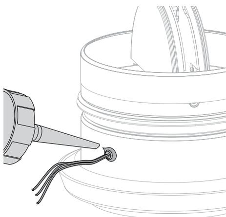
3. Inserire i cavi dei contatti dell'FCU attraverso il foro esternamente all'involucro. Sigillare l'apertura con silicone.
