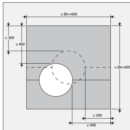
6. Il canale di ventilazione in cui è inserita la serranda non deve essere centrato nell'apertura (con dimensioni max. del canale + 600 mm). La distanza massima tra la serranda e il bordo dell'apertura è di 400 mm.
