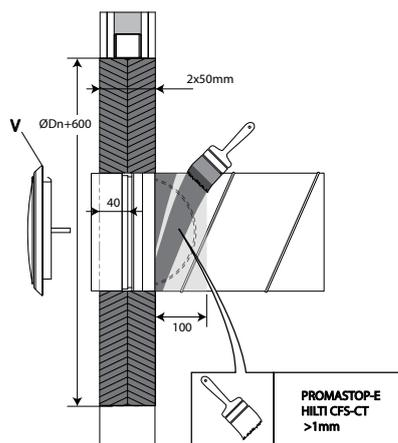
5. Il canale è provvisto di uno strato (>1,5 mm) di rivestimento endotermico (tipo PROMASTOP-E / PROMASTOP-CC / HILTI CFS-CT) per una larghezza di 100 mm sul lato dal quale fuoriesce la pala della serranda aperta.
