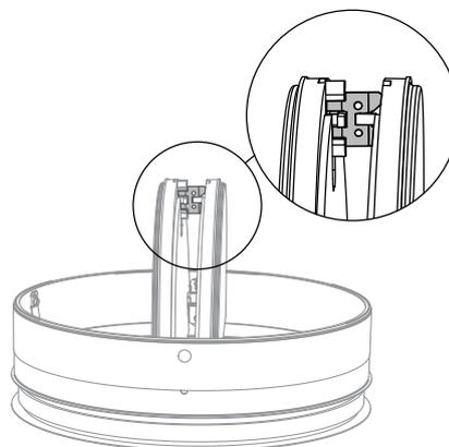
2. Sbloccare (chiudere) le pale della serranda premendole una verso l'altra. Liberare con attenzione l'elemento fusibile premendolo lateralmente.
