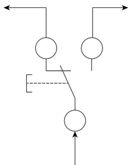
1. È possibile montare un interruttore di fine corsa (FCU) sul corpo in metallo. Lo scopo è determinare a distanza la posizione della cartuccia della serranda tagliafuoco circolare.
