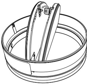
3. Inserire l'elemento fusibile nel supporto per bloccare le pale.
