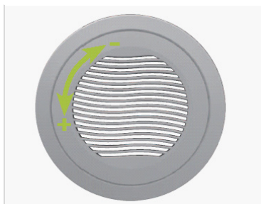
APERTURA (+) O CHIUSURA (-) DELL'OTTURATORE (POSIZIONE CHIUSA, 1 o 2) DELLA GRIGLIA
